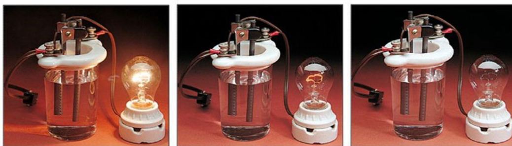
Рис. 23. Приборы для измерения электропроводности веществ
