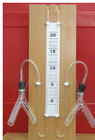
Рис. 19. Прибор для определения скорости химических реакций
