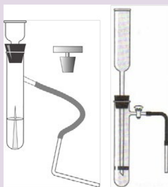
Рис. 7. Прибор для получения и собирания газов
