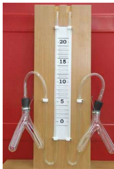
Рис. 19. Прибор для определения скорости химических реакций
